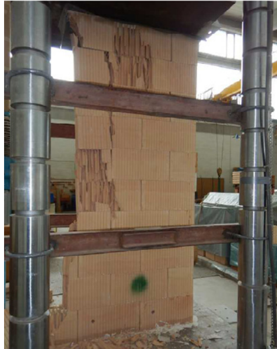
Bruchbild der Mauerwerksprüfung p+f expert AG
