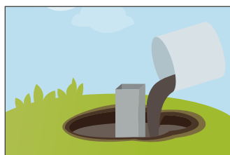
2. Trockenmaterial lagenweise einfüllen
