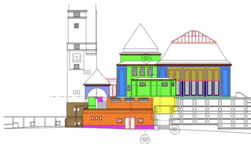
Der Putzauftrag des Fixit 222 ist an der Fassade nicht gleich und unterscheidet sich von Bauteil zu Bauteil.
