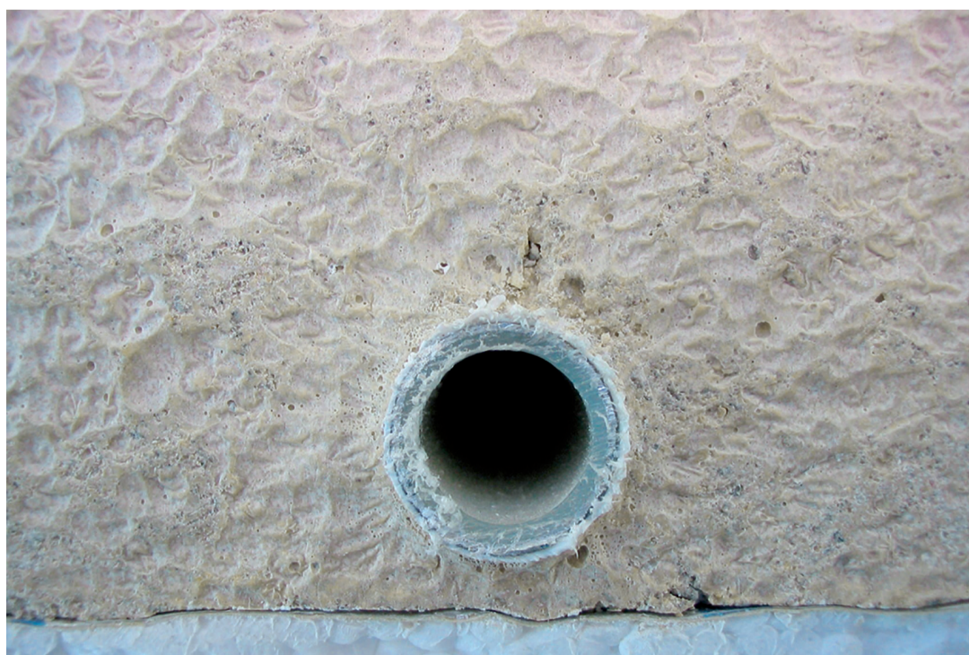
La structure fait toute la différence en matière de répartition de la chaleur : en haut la chape fluide à base de sulfate de calcium, qui entoure les conduites de chauffage, et en bas une chape poreuse en ciment.
