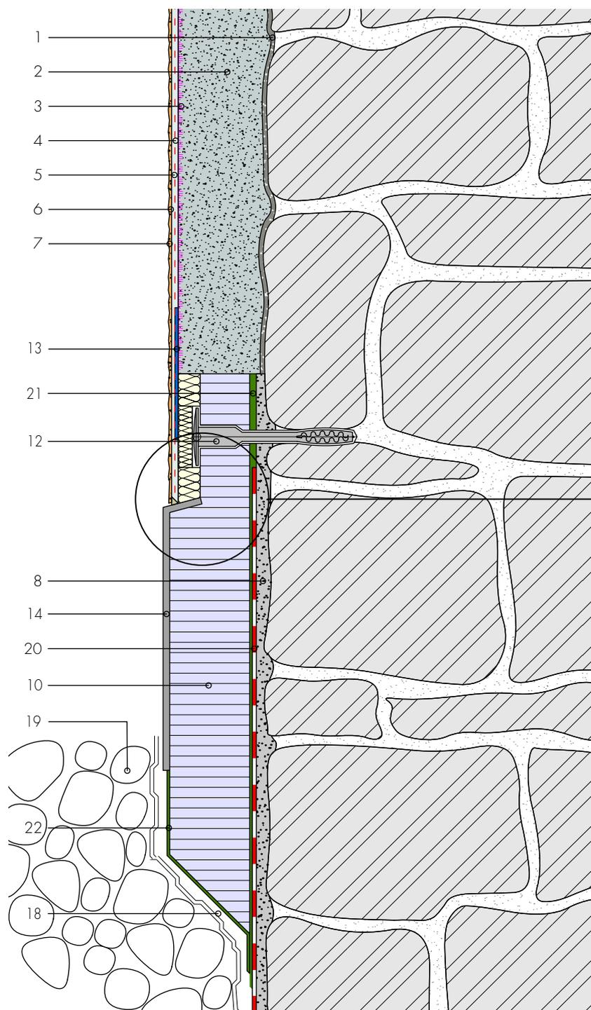
Raccord vers joint mastic caché avec coupe capillaire dans le crépi de finition
