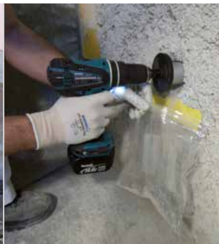
Prova dell'intonaco a contenuto salino
