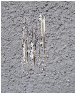
Parallelschnitt ungenügend tragfähige Beschichtung
