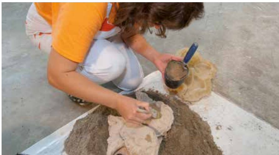
Obrada odljevaka pomoću RÖFIX Belit finog morta
