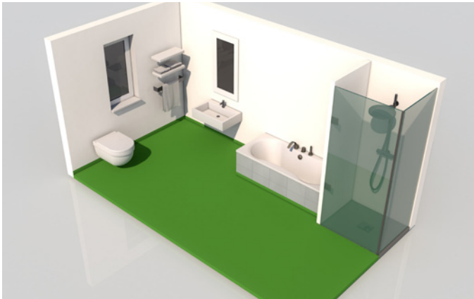
Abb. 4: Häusliches Bad mit Badewanne und niveaugleicher Dusche sowie Duschtrennung (grün = CAF, CTF; grau = CT)
