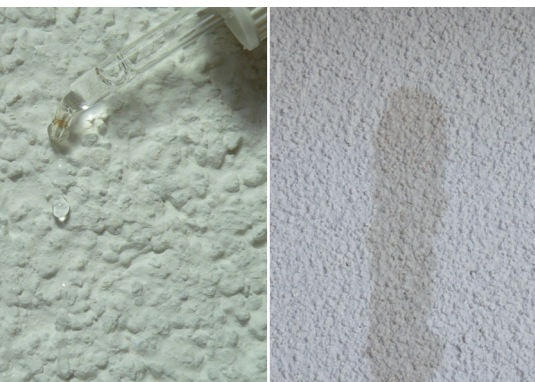
Foto a sinistra: sottofondo non assorbente Foto a destra: sottofondo assorbente
