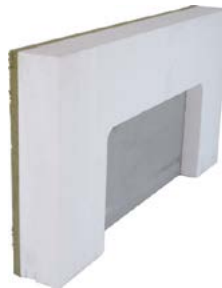
Schürzenelement Do-Tab mit Ausfräsung SWs Verstärktes MW-Schürzenelement mit Ausfräsung und Beschichtung für dem Sturzbereich mit Ausfräsung für Jalousien o.ä. sowie eingefräster Verstärkung.
