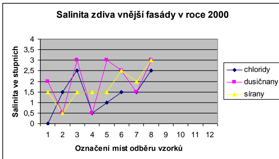
Obrázek 5.2.5 : Salinita zdiva vnější fasády v roce 2000
