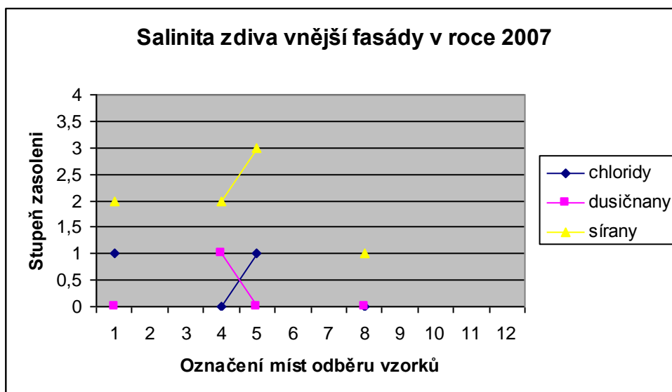
Obrázek 5.2.6 : Salinita zdiva vnější fasády v roce 2007
