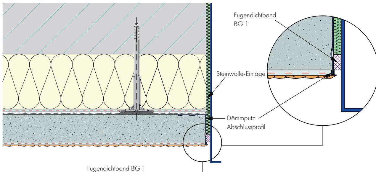
**Anschluss mit Abschlussprofil (Holz)**
