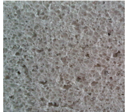
Querschnitt des ausgehärteten Hochleistungsdämmputzes
