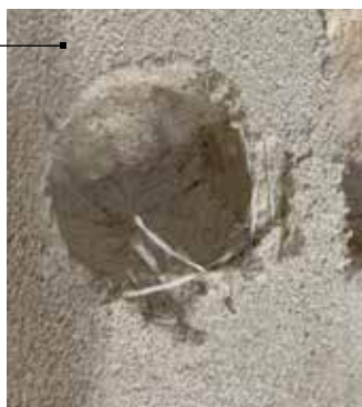
Probenentnahme an der Testwand
