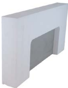
Schürzenelement Do-Tab mit Ausfräsung EPS Verstärktes EPS-Schürzenelement mit Ausfräsung und Beschichtung für dem Sturzbereich mit Ausfräsung für Jalousien o.ä. sowie eingefräster Verstärkung.
