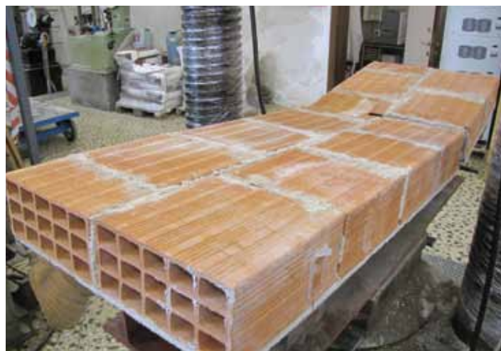
Campione di muratura non rinforzata sottoposta a flessione
