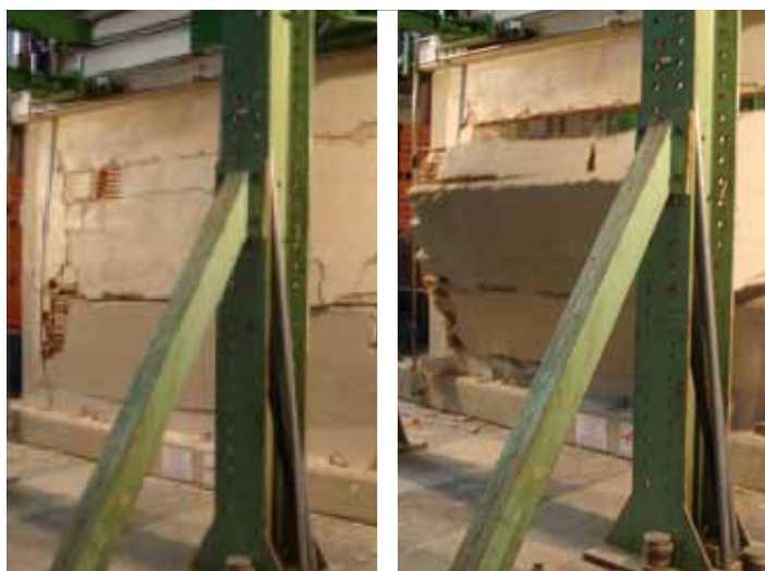
Foto del campione non rinforzato durante il test fuori piano
