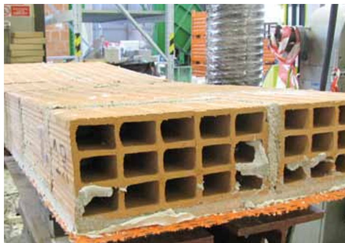
Campione di muratura rinforzata sottoposta a flessione
