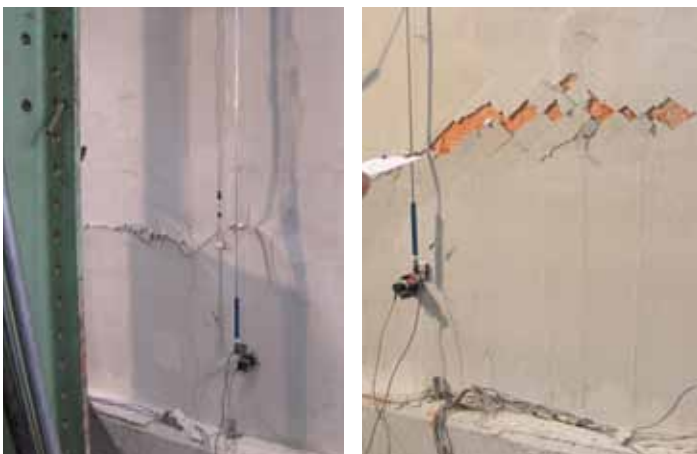
Foto del campione rinforzato al drift +/- 1.2%
