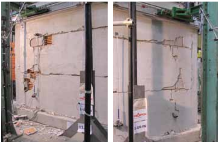
Foto del campione non rinforzato al drift del +/- 1.2%
