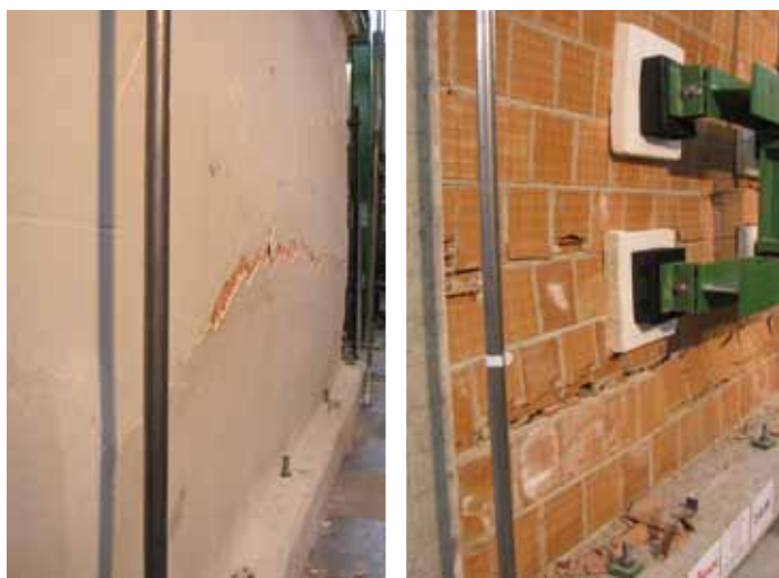
Foto della prova fuori piano del campione rinforzato
