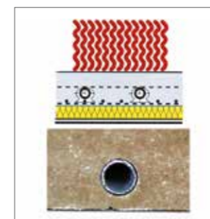
RÖFIX Samorazlivni estrih odlično obda cevi za ogrevanje
