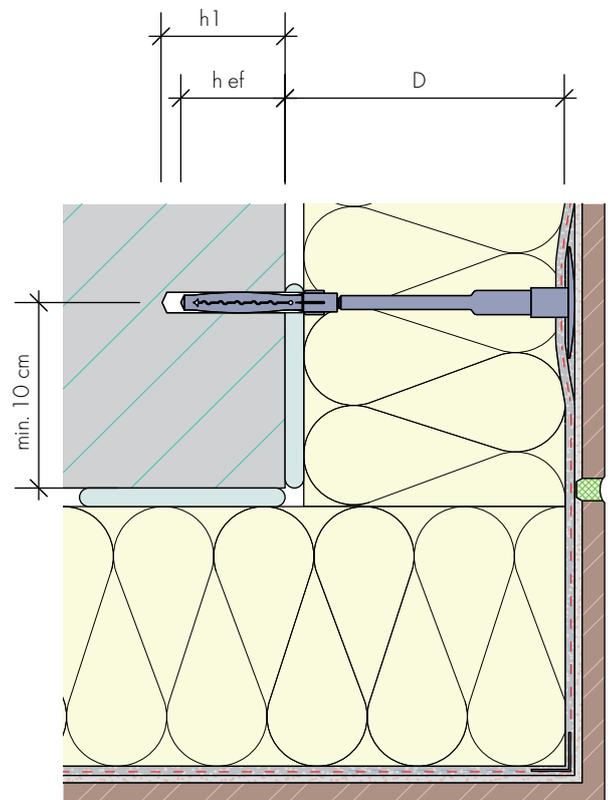
S.10.1 Disposition des chevilles pour un montage à fleur à travers le treillis.
