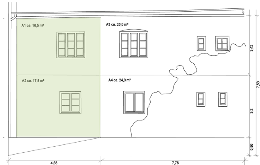
Bild 16: Übersicht über die 4 Messfelder der Westfassade des Nordbaus.
