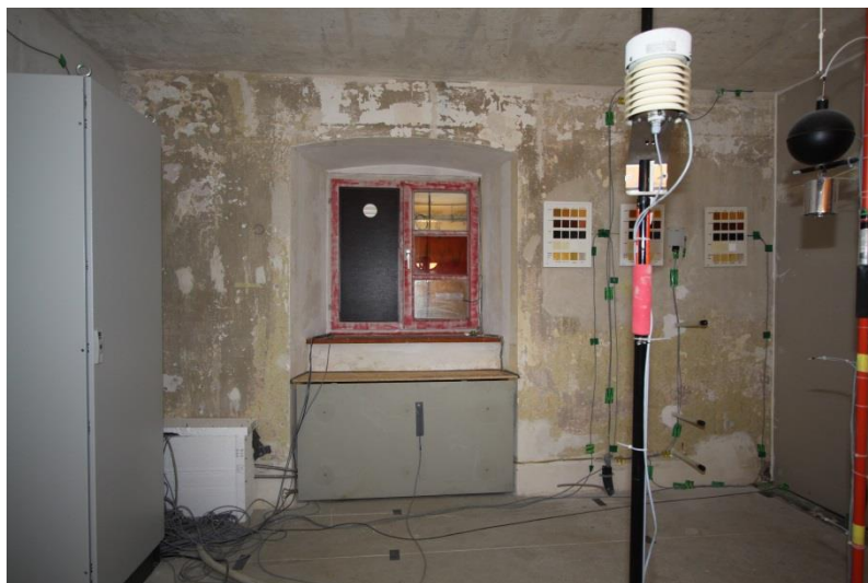
Bild 9: Innenraum des Messraums 1 ohne Innendämmputz.
