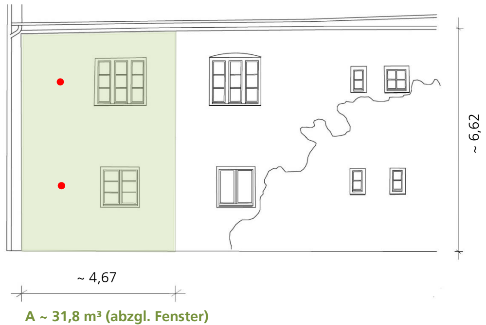
Bild 33: Testfläche und Messachsen in der Ansicht der Fassadenfläche.
