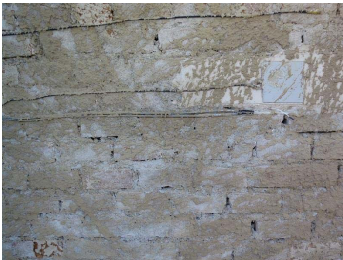
Bild 34: Sensoren zur Erfassung von Temperatur und relativer Feuchte sowie Wärme- flusssscheibe auf der Bestandsmauer, Feld A1 (Obergeschoss).
