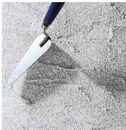
Malter za modeliranje – poluokrugla uska zidarska mistrija
