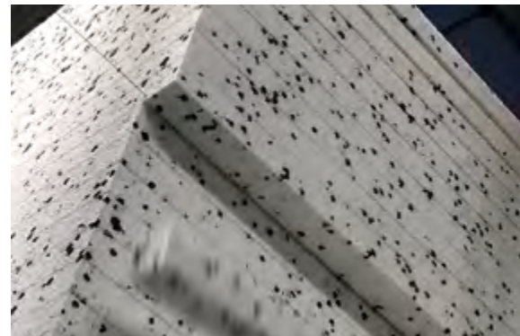
▲ Kantenbearbeitung: Stufenfalz und Nut & Feder werden gefräst. Bearbeitungsreste werden der Wiederverwertung zugeführt. Die hier zu sehenden grau gefärbten Anteile in der EPS-Platte sind durch Rezyklat-Zugaben entstanden.
