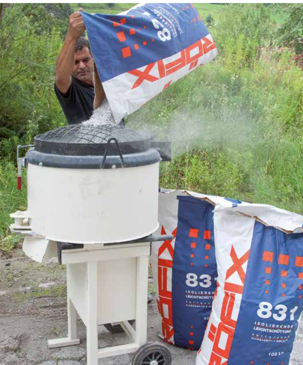
Mit Zwangsmischer und handelsüblicher Estrichpumpe verarbeitbar.
