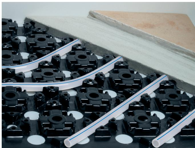
La CAF Fixit 830 evo est également appliquée juste au-dessus des plots des éléments de film, avec un recouvrement des tubes d'au moins 15 mm. Il en résulte ainsi une hauteur totale de pose d'au moins de 25 mm. Les trous poinçonnés garantissent une liaison solide avec le support traité préalablement et enduit.
