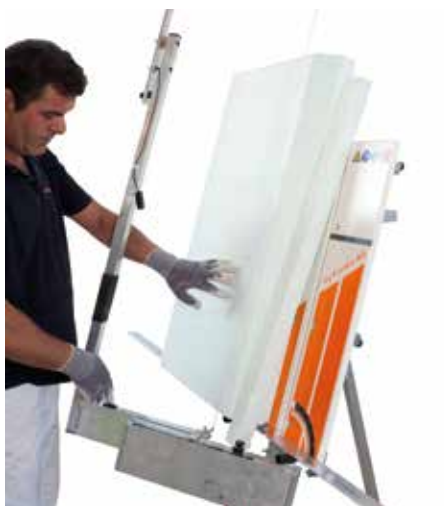
Koso rezanje izolacionih ploča za sokl pod uglom od 45°
