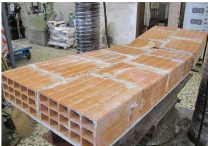
Nicht verstärkte Mauerprobe unter Biegedruck
