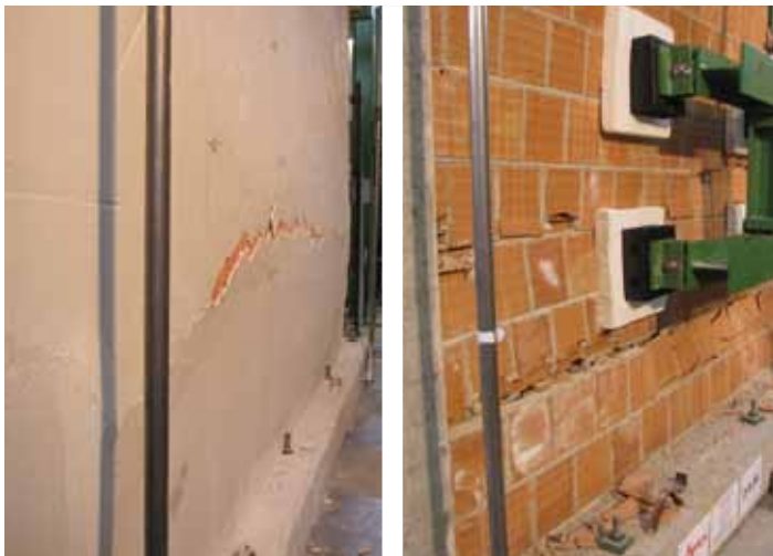
Photo des Tests bei maximalem Verformungsvermögen verstärkt mit RÖFIX SismaCalce
