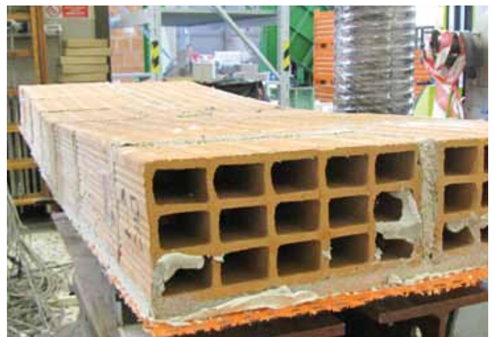
Verstärkte Mauerprobe unter Biegedruck
