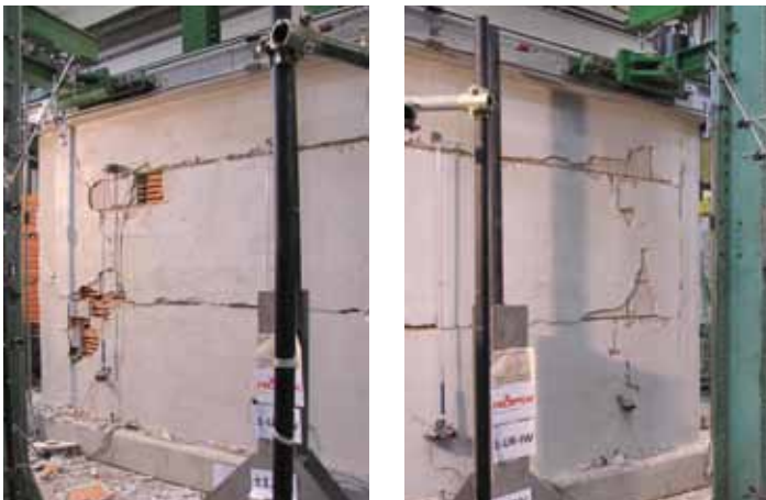
Photo der nicht verstärkten Mauerprobe beim drift von +/- 1,2%
