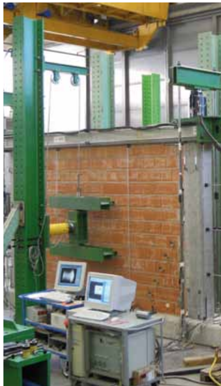
Frontalansicht des Testsystems unterhalb des Grenzwerts des max. Verformungsvermögens ohne RÖFIX SismaCalce
