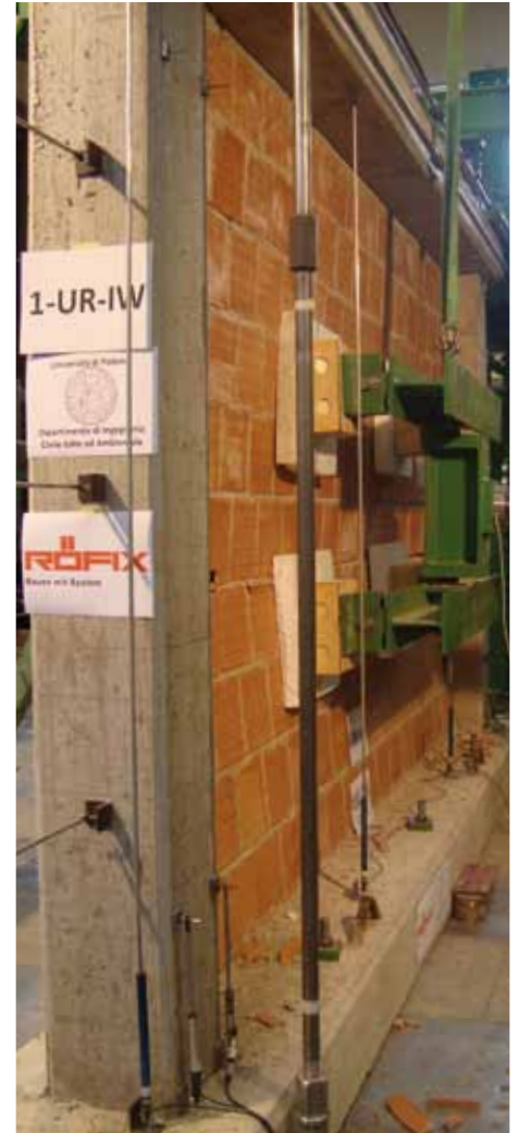
Seitenansicht des Testsystems bei max. Verformungsvermögen
