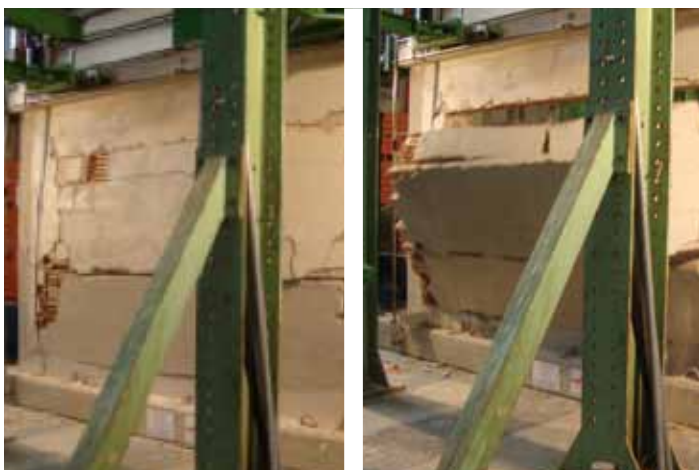
Photo der unverstärkten Mauerprobe während des Tests bei maximalem Verformungsvermögen
