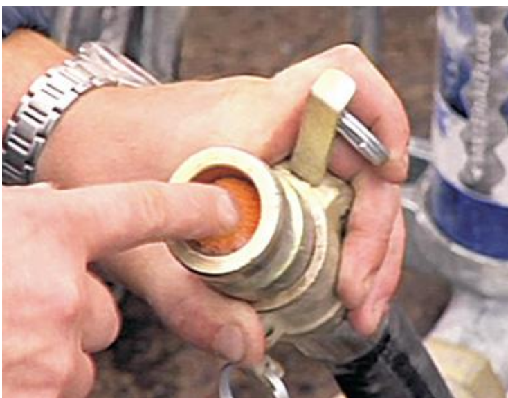
Fot. 15 Niezwykle ważną częścią prac prowadzonych w technice silosowej jest właściwa konserwacja sprzętu. Szczególnie narażone na zabrudzenia i uszkodzenia są agregaty tynkarskie i mieszarki, gdzie sypki i suchy materiał mieszany jest z wodą. Po zakończeniu każdego dnia pracy konieczne jest rozmontowanie i dokładne przepłukanie bieżącą wodą wszystkich elementów systemu mających kontakt z materiałem wymieszany z wodą. Dotyczy to także węży transportowych.
