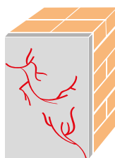
Fissure du crépi
