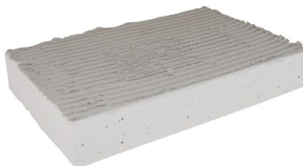
RÖFIX Minostar® wird vollflächig mit einer Zahraufel aufgetragen. Die Steghöhe der Klebewülste soll 10 mm betragen.
