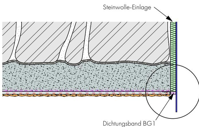
**Anschluss an Metallzarge mit Dichtungsband BG1**
