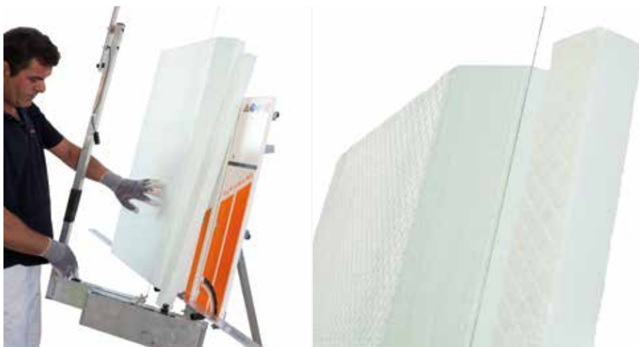
Poševen odrez izolacijske plošče za podzidek pod kotom 45 stopinj
