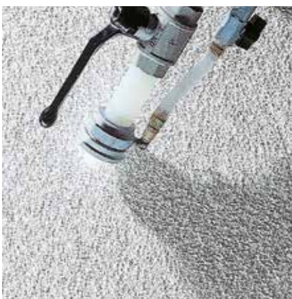
Brizgani omet – stroj za nanašanje finega ometa
