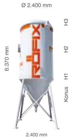
Silo-Neustellung bis ca. 10 Tonnen; Einblasmenge bis ca. 17 Tonnen; Silo-Rücknahme oder Umstellung bis ca. 10 Tonnen RÖFIX Baustellensilos werden im RÖFIX Produktionswerk unter Berücksichtigung der Mindestbefüllmengen mit dem gewünschten Material befüllt und an die Baustelle geliefert. Die möglichen Füllmengen eines Baustellensilos sind vom Schüttgewicht des abgefüllten RÖFIX Produktes abhängig.
