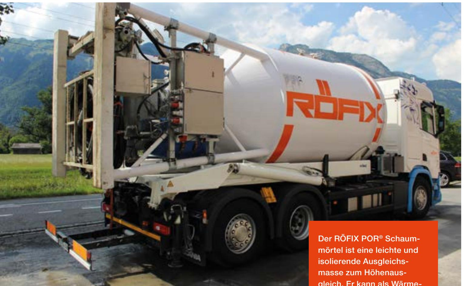
Der RÖFIX POR® Schaummörtel ist eine leichte und isolierende Ausgleichsmasse zum Höhenausgleich. Er kann als Wärmedämmung, als Ausfüllmasse oder im Schallschutz verwendet werden.
