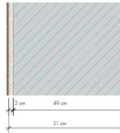
Wand mit Leichtgrundputz
