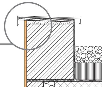
**Hauteur du bâtiment** inférieur ou égal à 8 m : surplomb de la couverture en tôle de 50 mm
