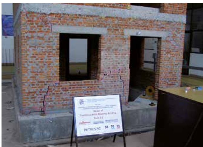
Oštećenje BM modela nakon zadnjeg ispitivanja intenziteta acc_{max}=0,22-0,35\text{ g}
