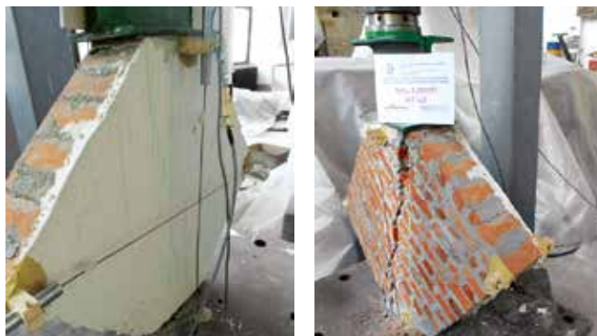
Karakteristike mehanizma sloma za zidne elemente W2-10S, W2-11S
