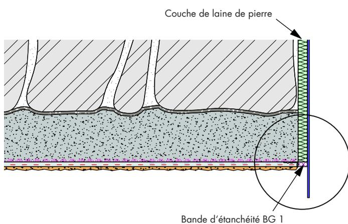
Raccord à huisserie métallique avec bande d'étanchéité pré-comprimée BG1
