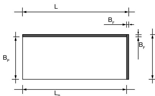
Calcul de la proportion du joint (min. 6 %)
