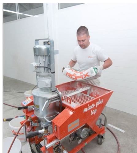
Maschinenteknik zur Verarbeitung von RÖFIX CalceClima® Thermo
