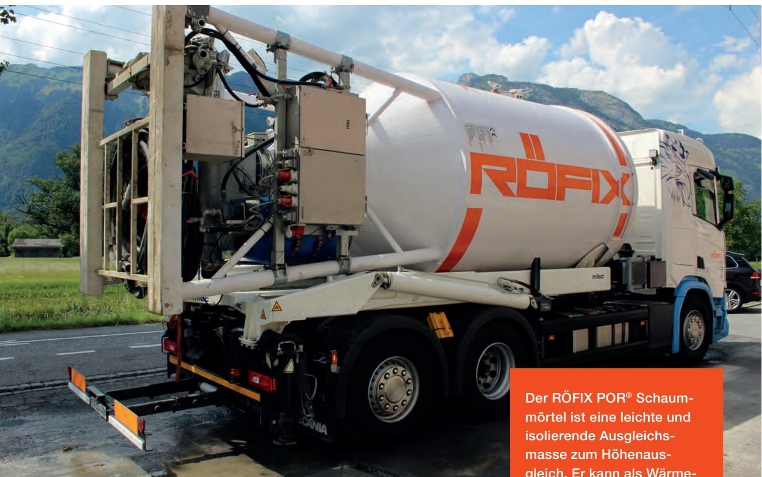
Der RÖFIX POR® Schaummoertel ist eine leichte und isolierende Ausgleichsmasse zum Höhenausgleich. Er kann als Wärmedämmung, als Ausfüllmasse oder im Schallschutz verwendet werden.
