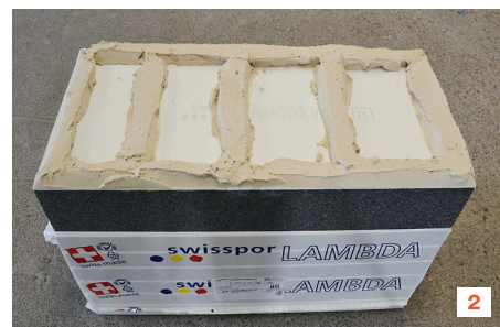
Kontrolle der Kleberkontaktfläche
