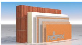
Il pannello isolante è componente omologato secondo ETAG 004 del sistema di isolamento termico a cappotto RÖFIX PURWALL.
