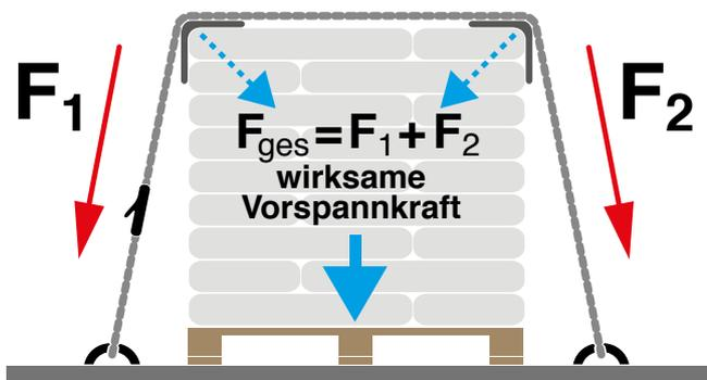
$F_{ges}$  = Gesamtvorspannkraft des verwendeten Zurrmittels in der Überspannung.
