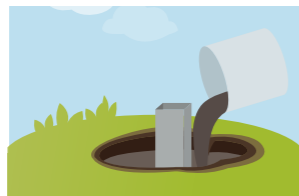
2. Trockenmaterial lagenweise einfüllen
