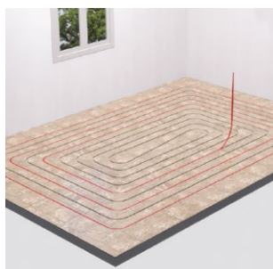
Posa della tubazione
