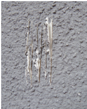
Coupe parallèle/couche insuffisamment porteuse
