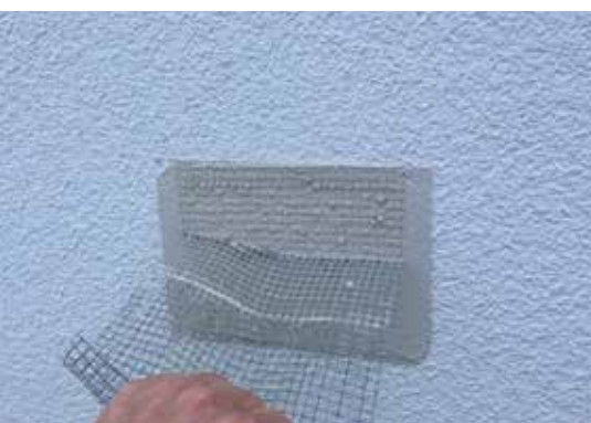
Préparation pour l'essai d'arrachage
