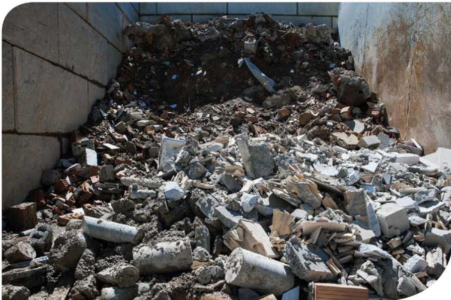
Als deponiepflichtige Baurestmassen werden bei Locker Recycling u.a. angenommen: Gipskartonplatten und -verschnitte, ausgehärteter Zement, Mörtel, Beton, abgeschlagener staubiger bröseliger Putz, abgeschabte Wandfarbe, Schlacke wie Schlackesteine und Fußbodenschüttungen, Verbund-Fassadenplatten, Abdichtungs- und Isoliermaterial, Glas, Sand & Kies.
