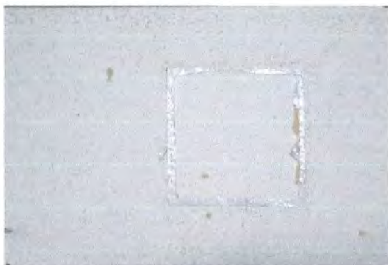
Рисунок 3 – Вигляд опоряджувального шару фрагменту дослідного зразка після гігротермальних циклів «тепло-дощ» та «тепло-холод»: а – № 42/24-1, б – № 42/24-2
