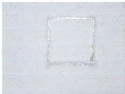
Рисунок 3 – Вигляд опоряджувального шару фрагменту дослідного зразка після гігротермальних циклів «тепло-дощ» та «тепло-холод»: а – № 42/24-1, б – № 42/24-2
