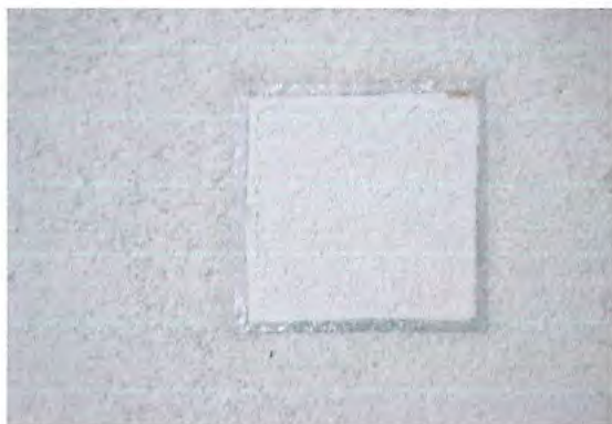
Рисунок 3 – Вигляд опоряджувального шару фрагменту дослідного зразка після гігротермальних циклів «тепло-дощ» та «тепло-холод»: а – № 42/24-1, б – № 42/24-2
