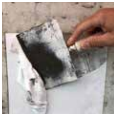
1 Prüfen des Untergrundes
